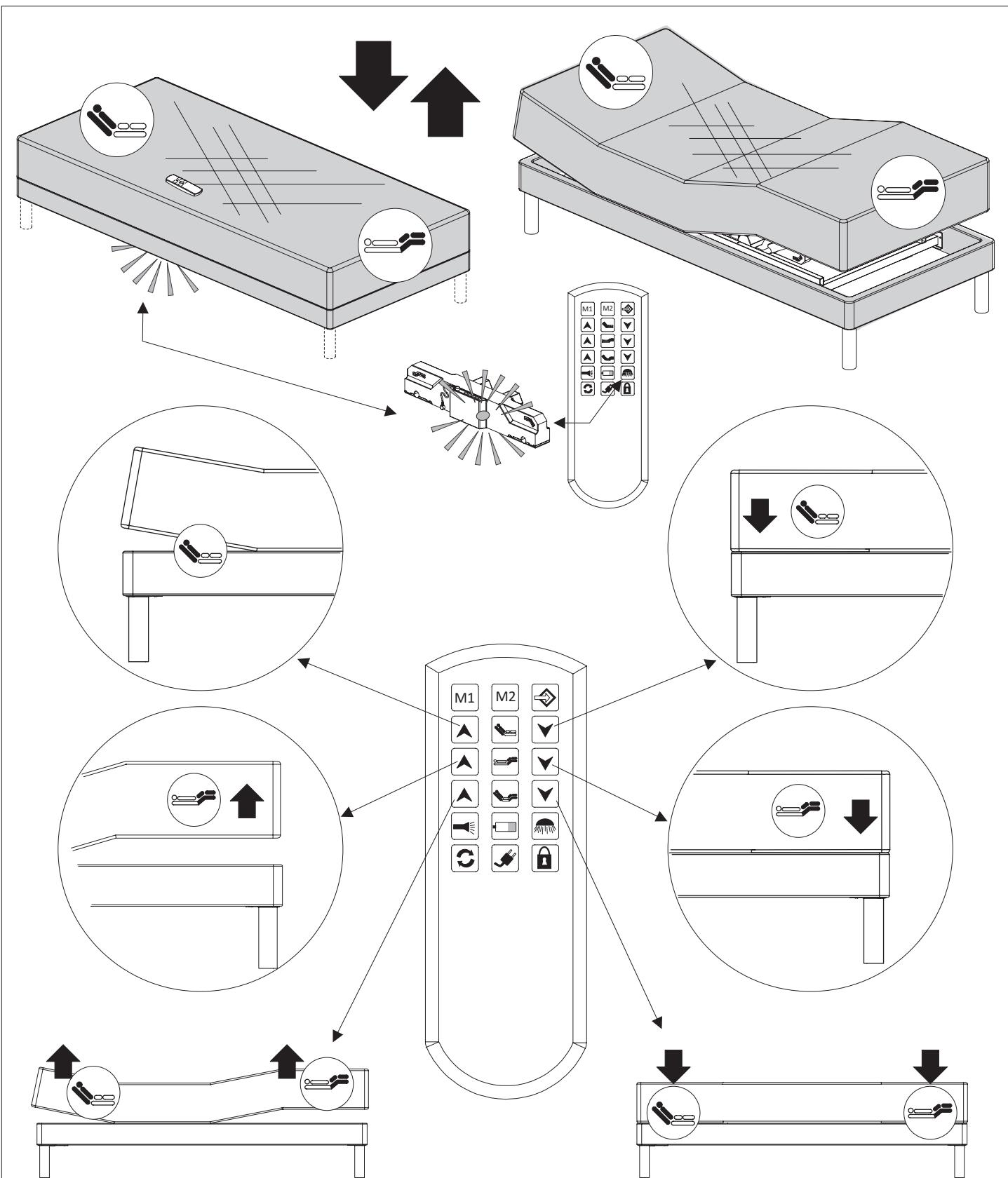
Tryk **M<sub>1</sub>** - Tryk derefter på **Nu lyser M<sub>1</sub>** - derefter skal vælges **▲▼**indenfor 2 sek. Gem den ønskede position ved at trykke **M<sub>1</sub>**
